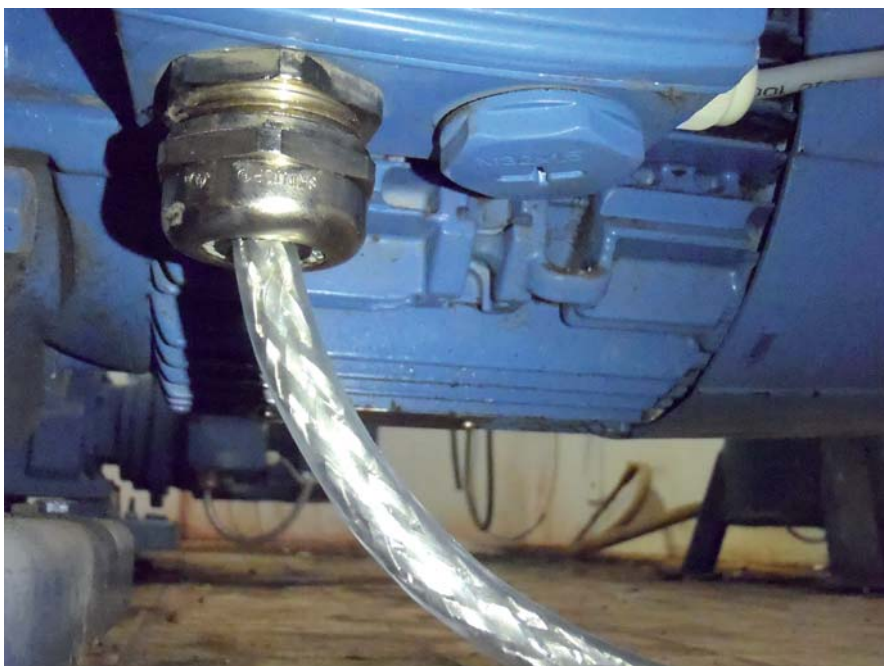
Rys. 5. Ölflex Servo 2YSLCY i Skintop MS-SC-M Brush. Przykład aplikacji: pompa cukrzycy zarodowej
