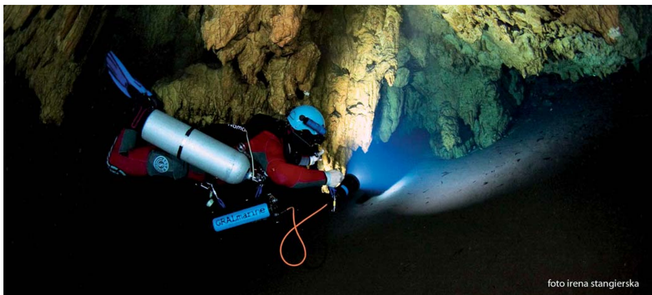
Rys. 1. Jaskinia Pit w Meksyku. Reflektor HMI 200 W wraz ze złączem oraz przewodem Ölflex 550P
