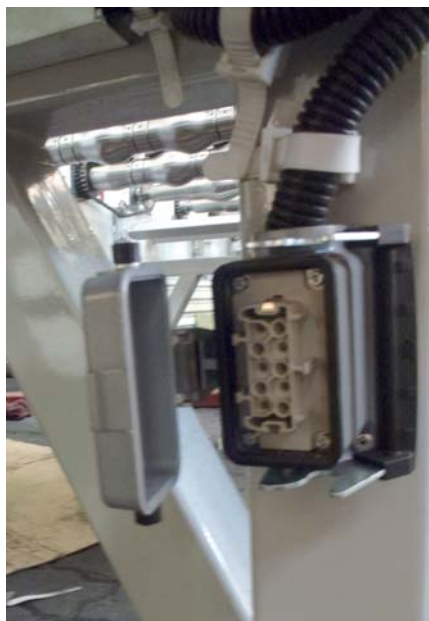
Rys. 4. Złącza Epic w maszynach produkowanych przez Bud-Masz
