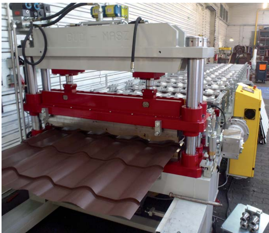
Rys. 1. Do zasilania napędów w maszynach produkowanych przez Bud-Masz wykorzystywane są przewody grupy Ölflex Classic 100
