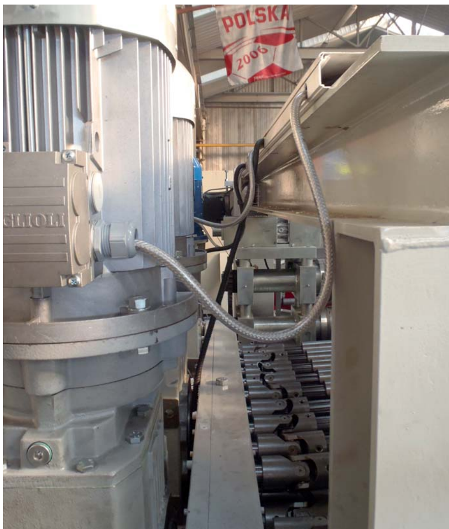
Rys. 2. Przewody Ölflex Classic 110 oraz ekranowane Ölflex Classic 110 CY w maszynach Bud-Masz
