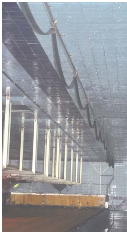
Rys. 5. Giętkie przewody serii Ölflex Lift w systemie podwiesi
