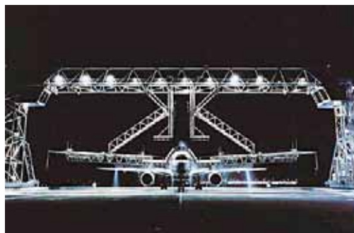
Rys. 1. Prowadnica stalowa BS 3500 z ramą wsporczą, zastosowana na stanowisku do odladzania na lotnisku w Monachium
