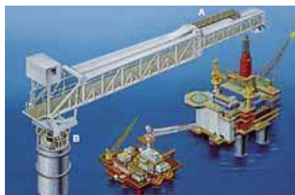
Rys. 20. Platforma Osenberg: A – prowadnica BS4500SL ze stali nierdzewnej; B – prowadnica BS4500SL ze stali nierdzewnej do ruchu obrotowego \pm 180^\circ
