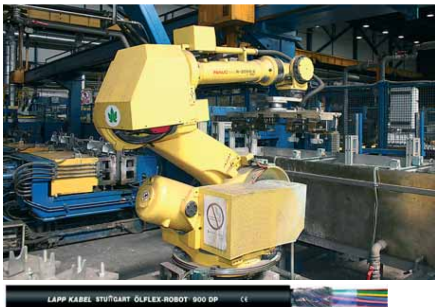
Rys. 3. Przewody odporne na skręcanie – Ölflex Robot 900 DP wykorzystano do podłączenia robota odbierającego zastygłe odlewy
