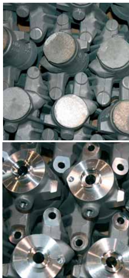
Rys. 5. Różnica w wyglądzie elementów przed i po obróbce mechanicznej
