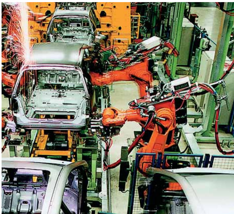
Rys. 2. W przypadku prac spawalniczych wykonywanych przez roboty konieczne jest zastosowanie przewodów o co najmniej 6. klasie giętkości, takich jak np. Ölflex FD 855P
