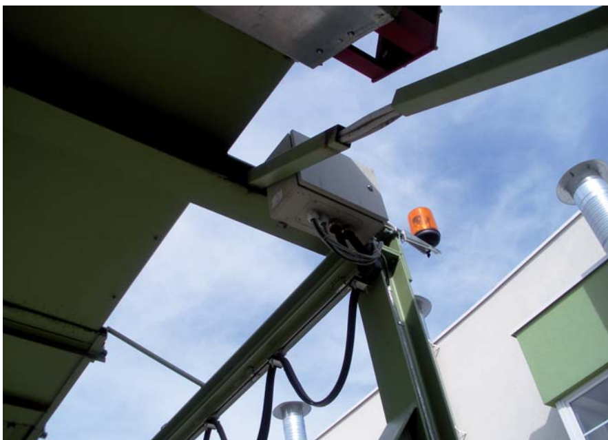
Rys. 9. Do zasilania napędów elektrycznych i elementów sterowniczych zasilanych poprzez system podwiesi wykorzystano płaskie przewody Ölflex Crane F
