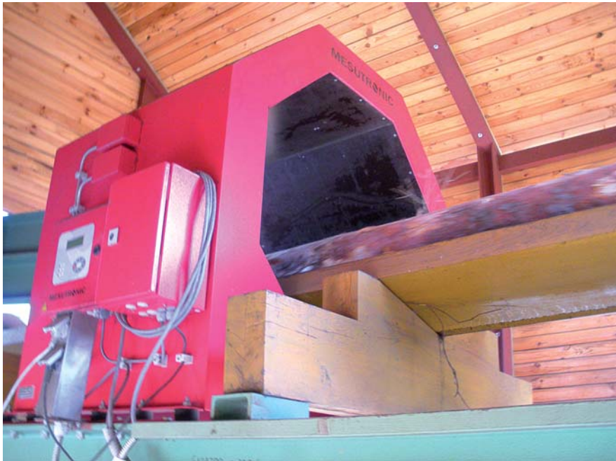
Rys. 3. Sortownik – bramka wykrywająca metal w kłódach
