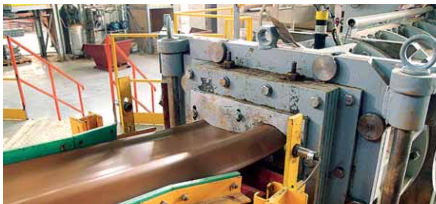
Rys. 2. Cięcie odpowietrzonej plastycznej gliny na galety
