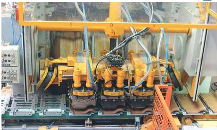
Rys. 3. Prasa stemplowa odciska trzy dachówki jednocześnie
