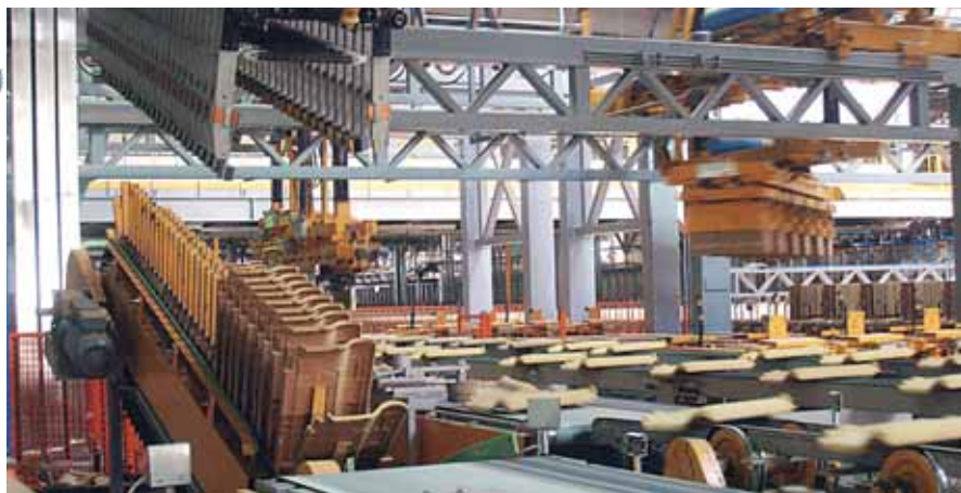
Rys. 5. Obracanie dachówek po nałożeniu angoby
