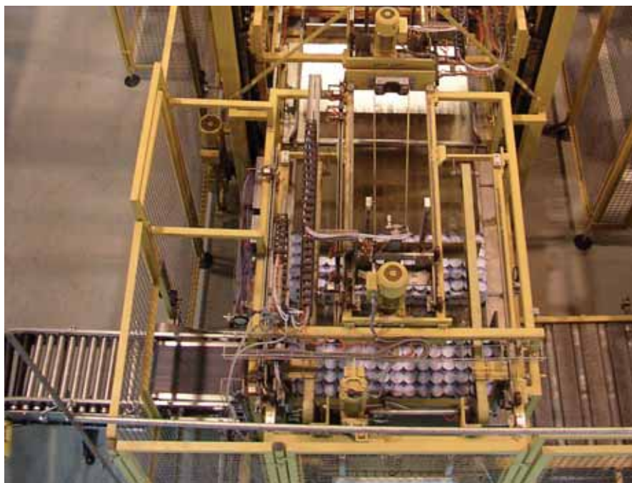
Rys. 9. Ruchome elementy pakowarek i paletyzatorów wymagają zasilania i sterowania przy użyciu przewodów kablowych zwanych łańcuchami
