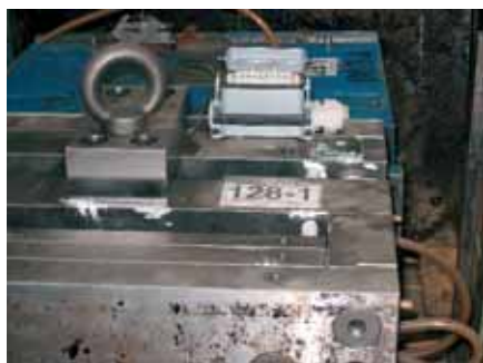
Rys. 3. Forma wtryskowa oraz zamontowane złącze Epic z dławnicą Skintop ST-M
