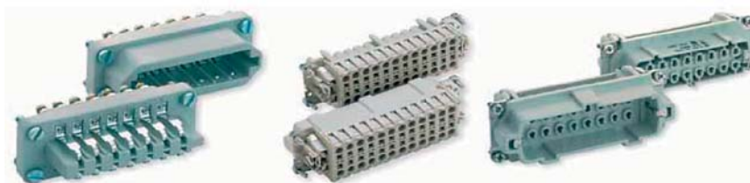
Rys. 3. Typy wkładów. Od lewej: wkład ze stykami „na śrubkę”; wkład ze stykami lutowanymi STA, samozaciskowymi HBE; wkład na styki zaciskane – toczone
