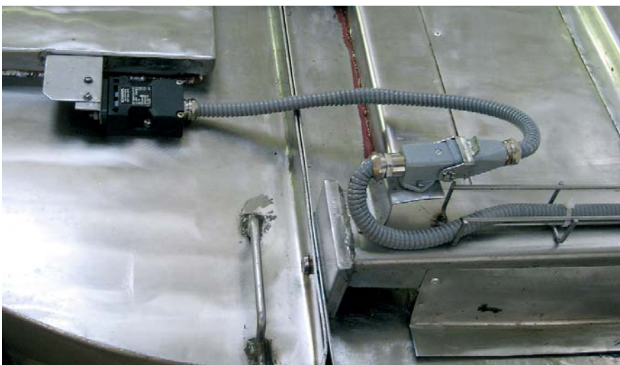
Rys. 5. Podajnik smaku – małe złącze EPIC
