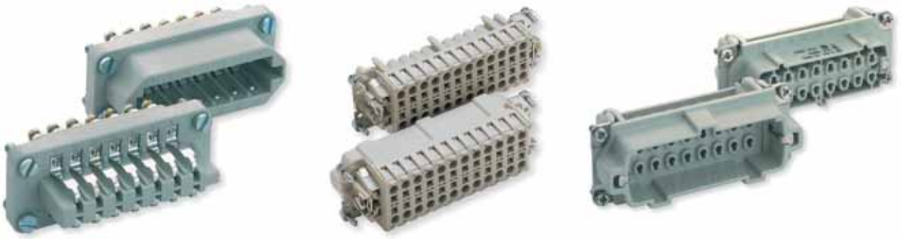
Rys. 9. Typy wkładów. Od lewej: wkład ze stykami „na śrubkę”; wkład ze stykami lutowanymi STA, samozaciskowymi HBE; wkład na styki zaciskane – toczony
