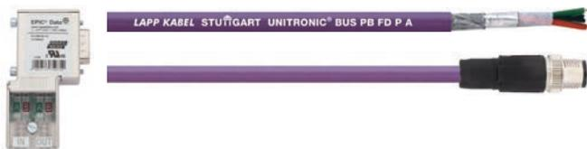
Могут применяться во всех основных fieldbus системах, среди которых PROFIBUS® (протоколы DP и PA), CAN, DeviceNet™, CC-Link®, AS-Interface, ISOBUS, Foundation Fieldbus™, KNX®. Кабели могут прокладываться как внутри, так и снаружи помещений. Стойкие к воздействию экстремальных температур. Подвижное, ограниченно подвижное или неподвижное применение. В наличии доступны штекеры B12 и Sub-D соединители, а также другие аксессуары.
