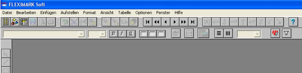
In der Bearbeitungsleiste finden sie rechts oben den Button mit dem roten EPLAN5-Logo. Um Daten zu importieren klicken sie auf den Button. Sie können den EPLAN-Import auch wahlweise die Funktion „Marking Data von EPLAN importieren“ aus dem Menü „Datei“ starten. Dies gilt für alle im Folgenden beschriebenen Funktionen. Sämtliche Funktionen können auch wahlweise über die entsprechenden Menüs gestartet werden.
