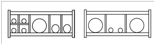
6. Кабели должны быть проложены симметрично относительно их веса и размера; т. е., с большим диаметром и весом ближе к краю, с меньшим диаметром и весом ближе к центру. Они также могут быть размещены в порядке убывания размера от центра к краям. Избегайте прокладки один над другим кабелей без использования горизонтальной перегородки.
