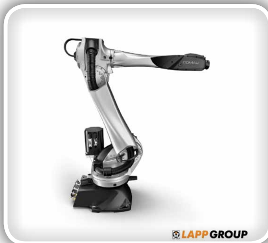
Racer 7 – košarkarski robot z zmogljivostjo 7 kg nosilnosti. Roke in motorji Racerja so manjše od tistih robotov v avtomobilski industriji zaradi svoje nižje nosilne zmogljivosti.
