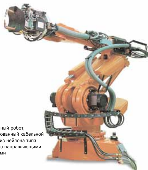
Сварочный робот с цепью для кругового вращения
