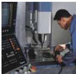
Изготовление литейных форм осуществляется с помощью современного станка с ЧПУ
