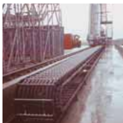
Применение цепи BS3500 с несущей рамкой в аэропорту в Мюнхене (Германия). Длина перемещения составляет 90 м, скорость - 90 м/мин.
