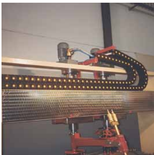
Цепь из нейлона (тип SR700). Применение: машина, работающая с мрамором
