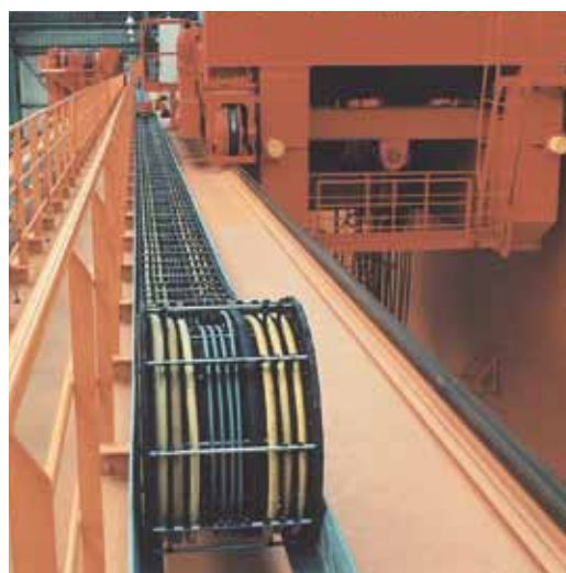
Цепь типа SR318 для перемещения на большие дистанции на грузоподъемном кране
