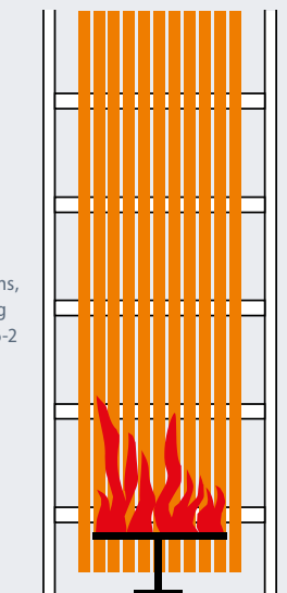
Fig. 2 Brandverhalten von Kabelbündeln, Prüfanordnung nach IEC 60332-3, EN 50266-2
