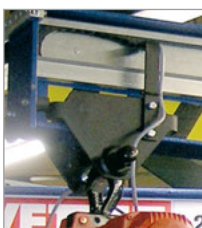
MONO cable carriers on a pillar jib crane Photographs: VETTER Fördertechnik GmbH
