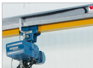
MONO cable carriers on a pillar jib crane Photographs: VETTER Fördertechnik GmbH
