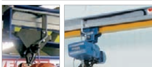
MONO cable carriers on a pillar jib crane Photographs: VETTER Fördertechnik GmbH
