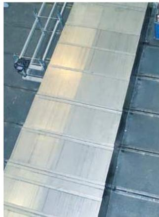
Die Bettbahnen sind mit Tandemabdeckungen geschützt, so werden kleine Außenabmessungen auch bei langen Verfahrwegen ermöglicht.
