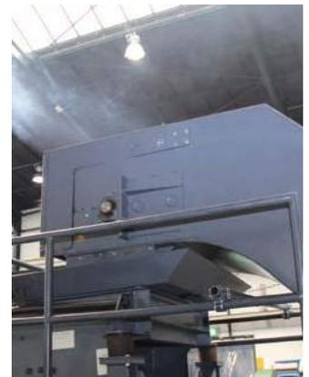
Durch eine spezielle Schwingrinne unterhalb des Fördererabwurfs werden lange und kurze Späne voneinander getrennt.
