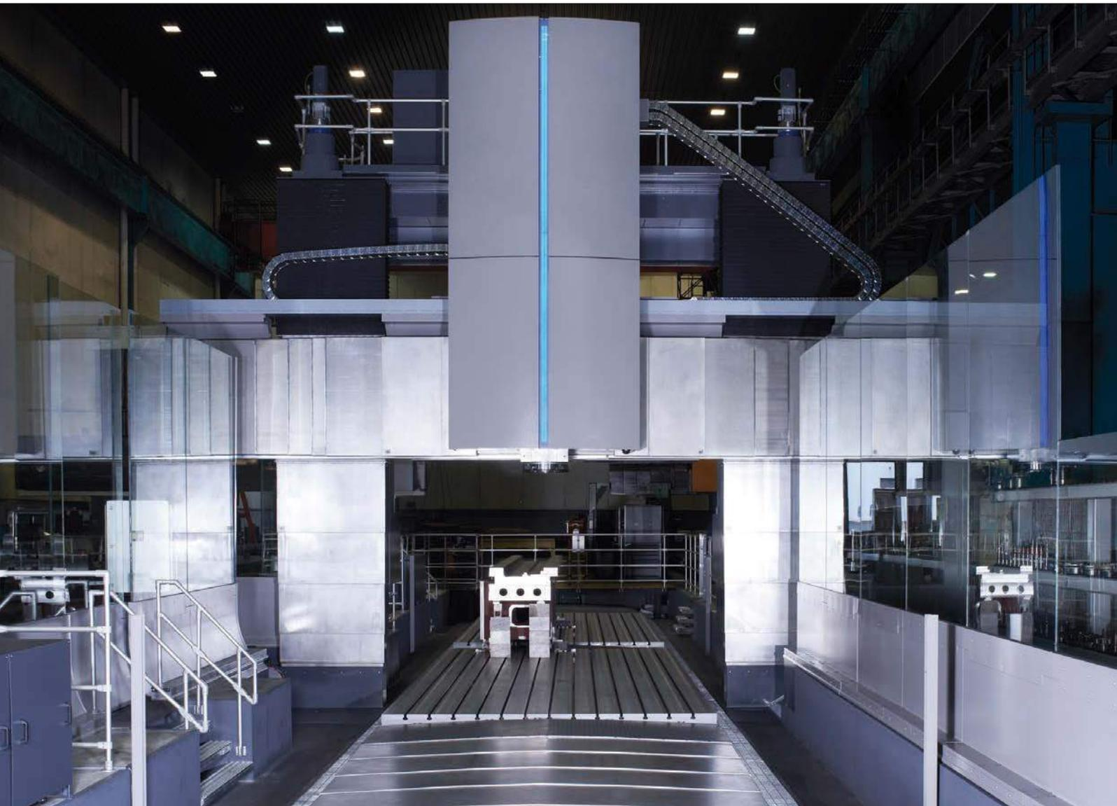
Zahlreiche Komponenten von KABELSCHLEPP® wurden verbaut – von Energieführungsketten über Teleskopabdeckungen bis hin zu Späneförderern.
