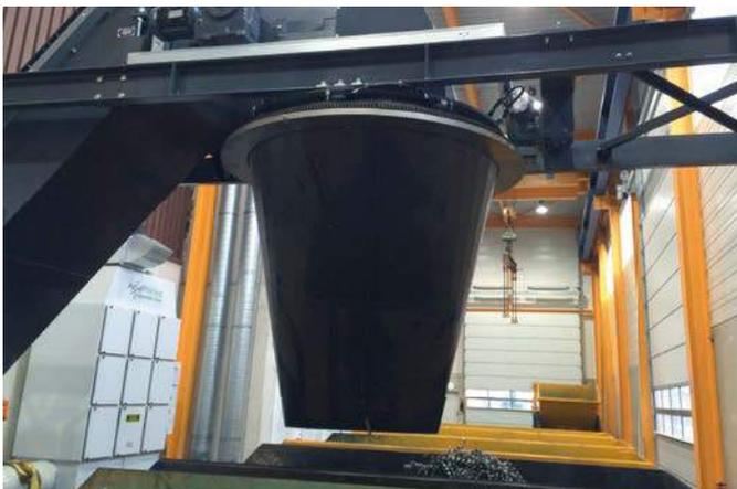
Optimierung des Füllgrades durch schwenkbare Rutsche.
