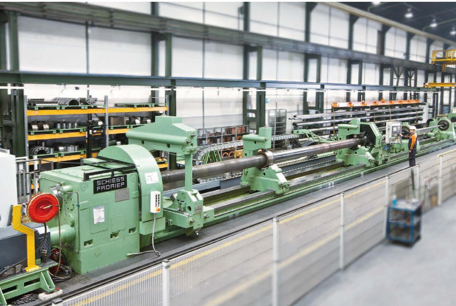
Die mächtigen Dimensionen der Tieflochbohrmaschine des Fabrikats Schiess-Friepe sind zum Beispiel zur Produktion von Rohren oder Propellerwellen erforderlich.
