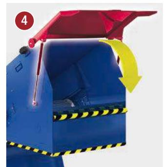
**Revisionsklappe** am Abwurf sichert vor unbefugtem Eingriff.
