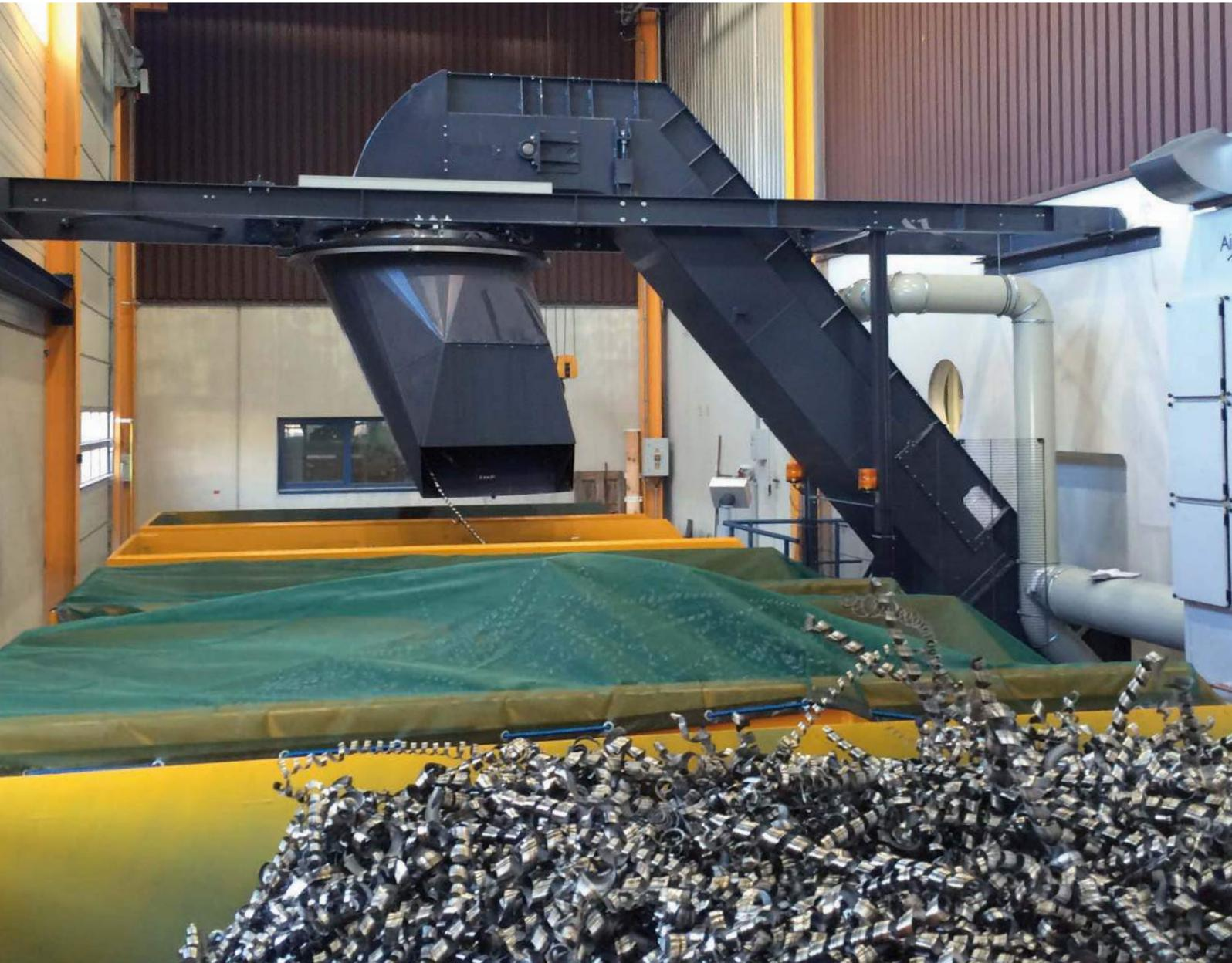
Spänentrennung und Verteilung an einer Schälmaschine.
