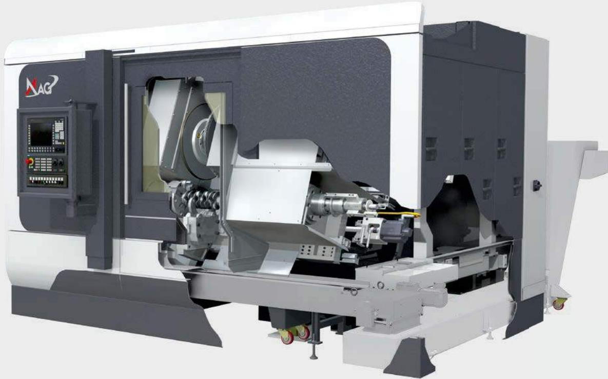
Eine Kombination aus Längs- und Querförderer entsorgt die Späne an der Kurbelwellenbearbeitungsmaschine von MAG IAS.
