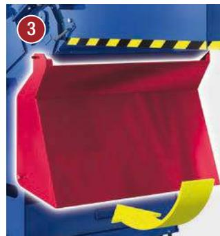
**Behälterabfrage** mit Stopp-Funktion bei fehlendem Behälter.
