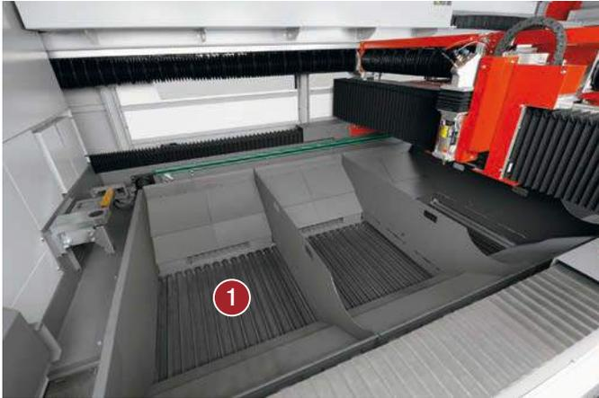
WAVE-BELT Förderer innerhalb der Maschine.
