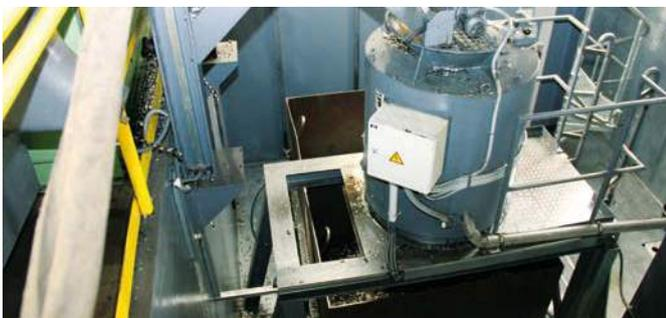
Die Zentrifuge dient zur Entölung von kurzen, ölbehafteten Metallspänen. Das Öl wird ausgeschleudert und dem Kühlschmierstoffkreislauf wieder zugeführt. Die „trockenen“ Späne werden in ein spezielles Containersystem abgeworfen. Stillstandzeiten durch Containerwechsel gibt es nicht.
