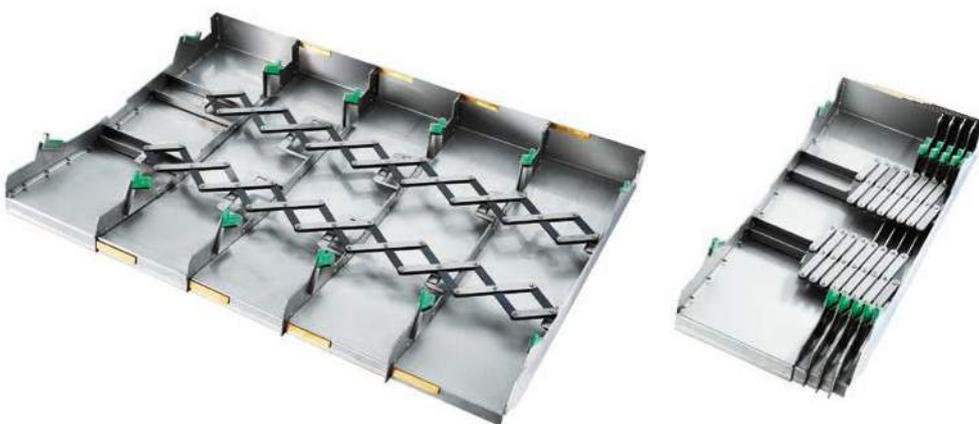
Alle Abdeckkästen werden während des Auszuges und des Zusammenschubes gleichmäßig bewegt. Die einzelnen Kästen bewegen sich relativ zueinander nur mit einer Differenzgeschwindigkeit. Die Scherenmechaniken eliminieren Kraftspitzen und verhindern störende Anschlagimpulse durch das Aneinanderschlagen der einzelnen Teleskop-Abdeckungskästen. **Hohe Verfahrensgeschwindigkeiten bis zu 200 m/min. sind möglich.**
