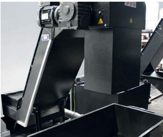
Späneentsorgung in Spänecontainer oder Austragsförderer.
