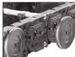
Glidskivor för lång livslängd vid tillämpningar där kedjesläpet är vridet 90°, samt i styrrännor.
