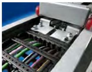
Automatiskt nödstopp med urkoppling av kabelsläpkedjan.
