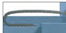
■ Kabelsläpkedja utan extra belastning (kablar och slangar)
