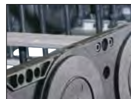
Skruvade stag och lock för högsta stabilitet även vid stora bredder.
