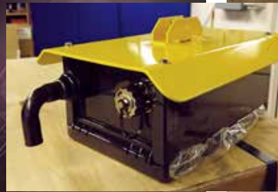
KAPSLINGEN SOM SKYDDAR ANTENNEN FÖR 5G. SE MONTERAD I SCHAKTET OVAN.
