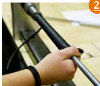
SPIRALISERING AV KABELN, UPPRULLNING PÅ DORN.
