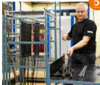
DORN AVLÄGSNAS EFTER ATT DEN SPIRALISERADE KABELN SVALNAT.
