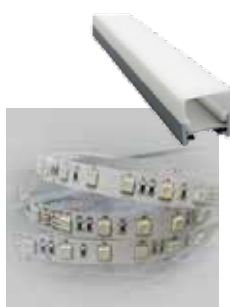
MATERIAL SOM ANVÄNDS I GOTHIA TOWERS: 14,4W/M RGB LED, FLEXIBLA STRIPES, SAMT PROFIL MED ETT UTSKJUTANDE FYRKANTIGT OPALGLAS SOM GER JÄMN LJUSFÖRDELNING OCH SPRIDER LJUSET 180°.
