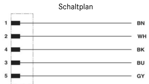
Kontaktbelegung des M12-Steckers und der M12-Buchse
