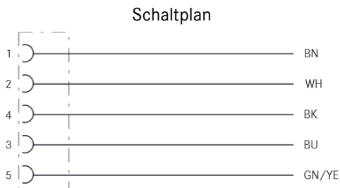
Kontaktbelegung der M12-Buchse
